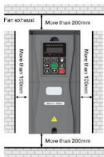
شکل ۲-۳ نصب چندین اینورتر
