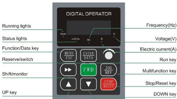
شکل ۳-۴ دیاگرام پنل کنترل
